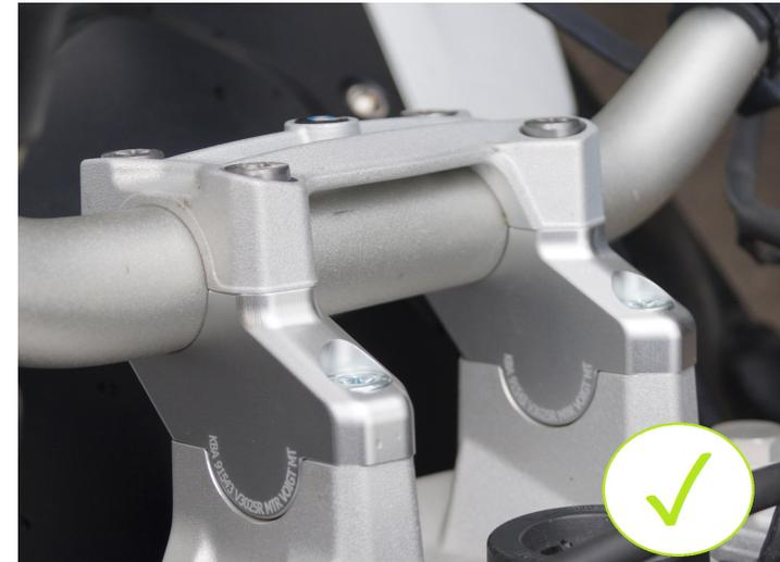
**Hinweis:** Bitte achten Sie nach erfolgter Montage darauf, dass auch bei voll eingeschlagenem Lenker der Brems- und Kupplungsschlauch, Züge und Kabel weder spannen noch scheuern!
