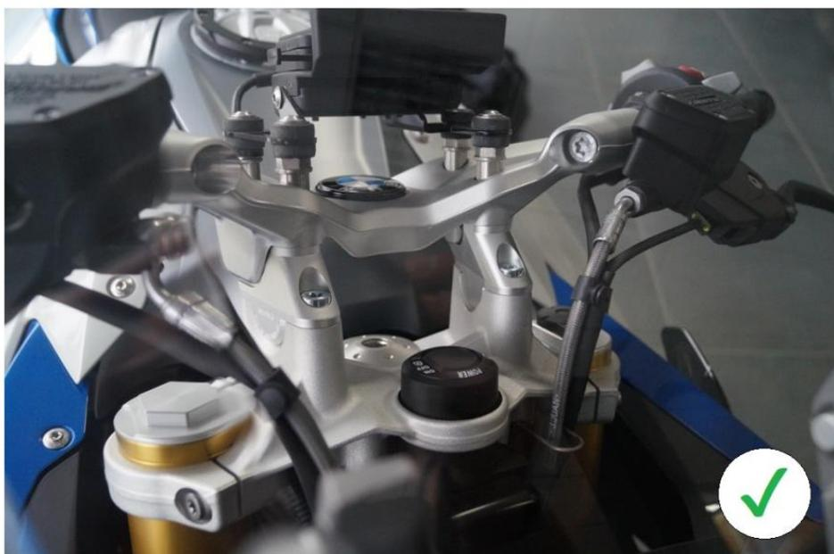
**Hinweis:** Bitte achten Sie nach erfolgter Montage darauf, dass auch bei voll eingeschlagenem Lenker der Brems- und Kupplungsschlauch, Züge und Kabel weder spannen noch scheuern! **Note:** Please ensure that the brake and clutch hose and cables are not tensioned or chafed even when the handlebar is at steering stop.
